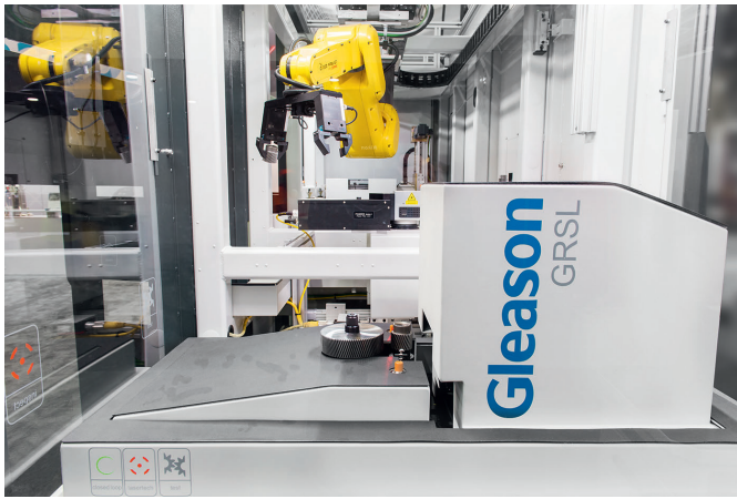
2 GRSL – Zweiflanken- wätzprüfung mit integriertem Laserscanner
